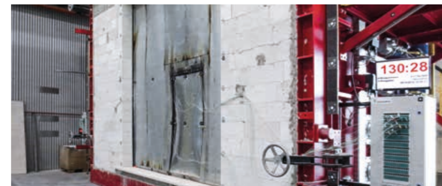
Tűzállósági vizsgálat A kapu állapota 130 perc elteltével
